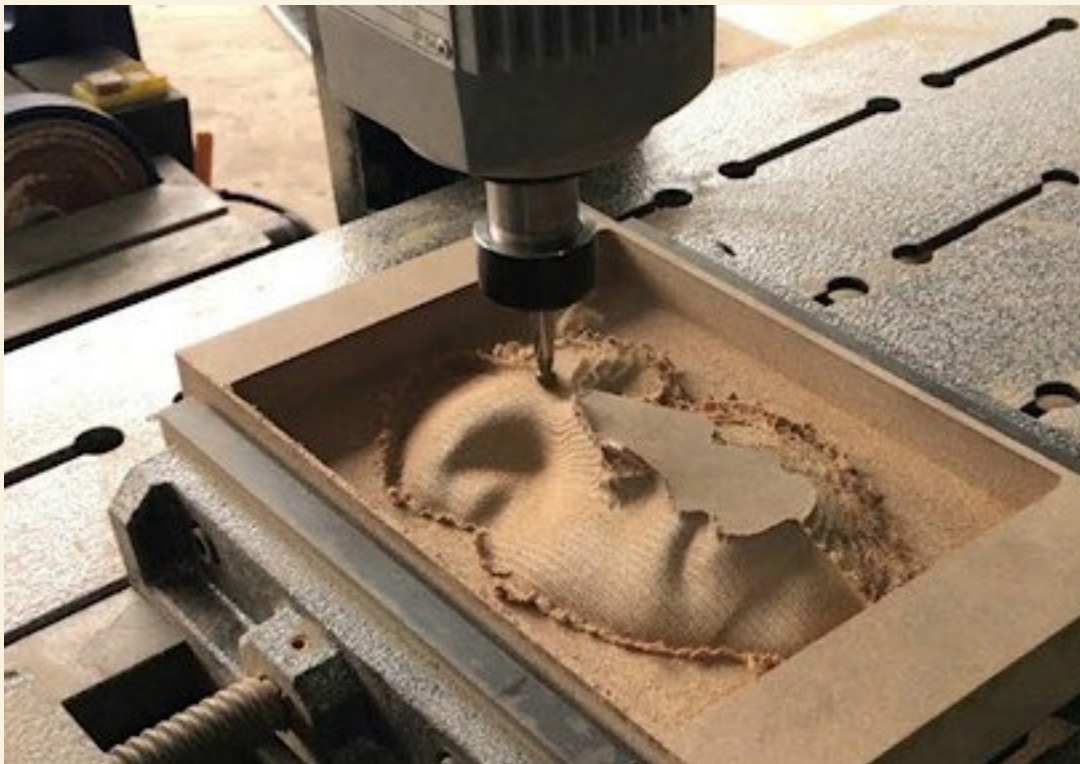
Fig. 6 – Figura sendo esculpida em CNC
